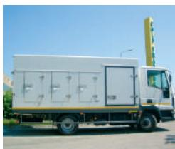
La carrozzeria è dotata di un solo gruppo frigorifero che alimenta entrambe le batterie di piastre eutectiche sia quelle per la bassa temperatura che quelle per la temperatura positiva.
